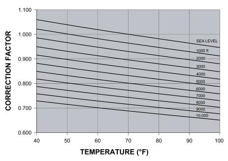
FIGURE 16 - ALTITUDE/TEMPERATURE CONVERSION FACTOR
